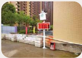
揚塵監測設備
