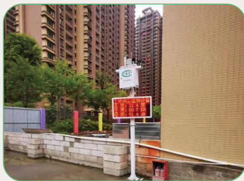
揚塵監測設備
